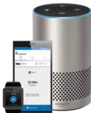
Con EasyStart Web puoi controllare il tuo riscaldatore sempre e dovunque, indipendentemente da dove ti trovi e dove è parcheggiato il tuo veicolo. Si tratta di un sistema di controllo remoto basato sul web, che utilizza un server dedicato per ricevere i comandi dalla app per smartphone e inviarli al riscaldatore sotto forma di dati utilizzando la rete telefonica cellulare. L'utilizzo non potrebbe essere più semplice, e non ci sono limiti di distanza:
